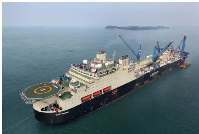
最新鋭の深海専用パイプライン敷設船「カストローネ」
