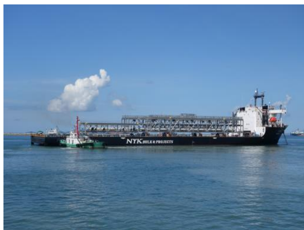
タイから出荷された LNG プラントモジュール
