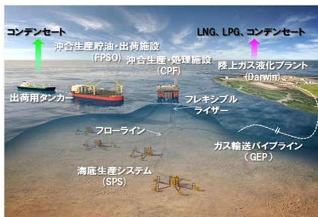
沖合生産施設完成イメージ
