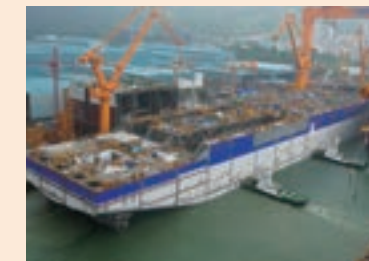
FPSO 進水の様子
