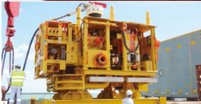
1:沖合生産・貯油出荷施設（FPSO）の建造作業の様子 2:生産井掘削リグ“ENSCO5006” 3:海底坑口装置 4:沖合生産・処理施設（CPF）のフローティングドックにおける建造作業の様子
