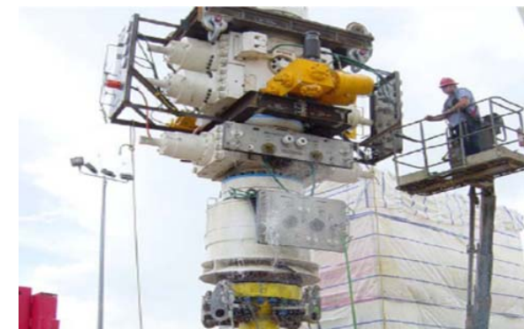
キャッピング装置 (暴噴時に海底の暴噴制御装置が作業不良に陥った際の備えとして使用するもの)
