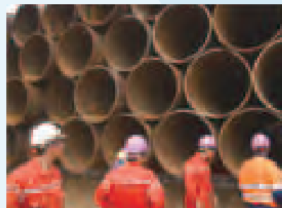
コーティングのためマレーシアに運搬された直径42インチのパイプライン
