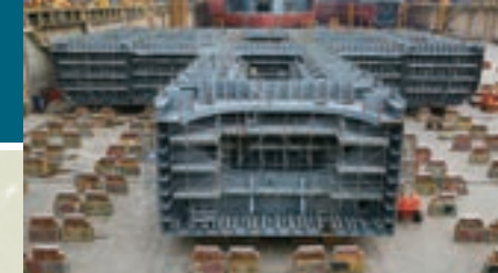
FPSO 船体の組み立て作業風景
