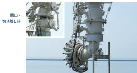
ERS (Emergency Release System) は、荷役中に地震による津波や火災、異常気象・海象などの緊急事態が発生した場合、アンローディングアーム内の流体の排出処理を行うことなく、短時間でアンローディングアームを船舶から切り離すシステムです。
