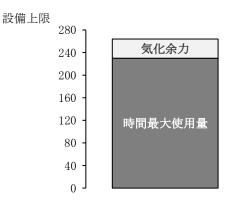
上図は、当社で予定しているピーク日における気化器の時間最大使用量のイメージを示したものです。 気化余力は34t/h (製造計画策定値を基に算出)となりますが、LNGの供給変動、ガスの需要動向、定期 検査、予定外設備工事等により変動します。
